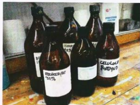
Ole Dufours arsenal af rensesvæsker er ikke for sarte sjæle. Det allervanskeligste man kan blive udsat for er en såkaldt ådring fra 1800-tallet. De farver kommer af blyhvidt, som dækkede godt og imprægnerede træet, men den er forbudt i dag. Ulempen ved farven er, at farven bliver lige så hård som ben, når den har siddet i 100 år, og så er man nødt til at sidde med isedikke og dryppe helt forsigtigt, så man ikke skader mere sårbare lag inde bagved.
