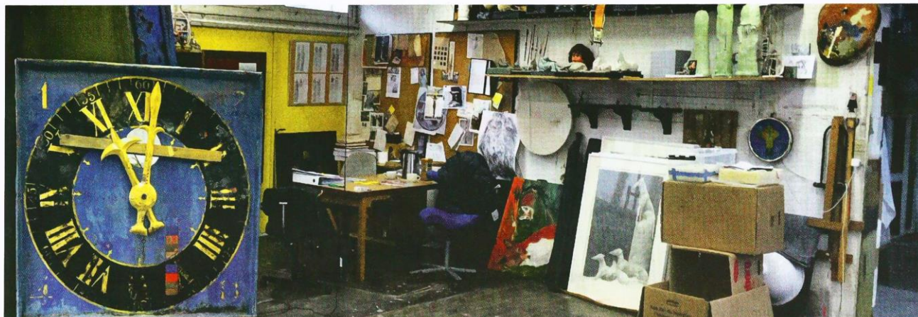
Urskiven fra Søborg Kirke i Gilleleje er på Nationalmuseets bestilling blevet undersøgt af Ole Dufour, der har afdækket at den er i sin tid blev udformet i kobber, som det ses på firkanterne til højre, hvor farvekonserveren har arbejdet sig igennem de forskellige lag.
